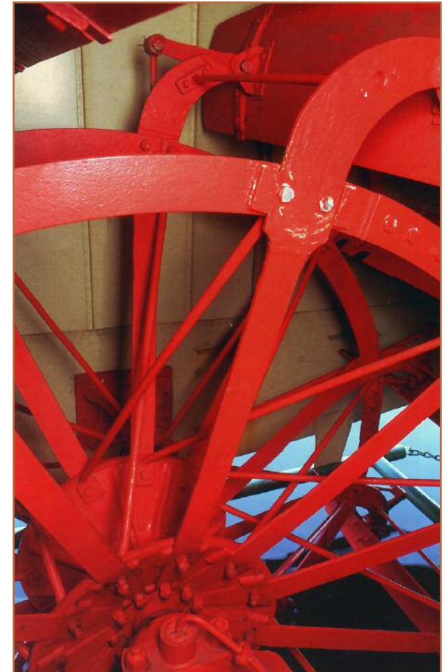
Abb. 3: Blick durch das Fenster auf ein Patent-schaukelrad mit beweglichen eisernen Schaufeln, zeigt u. a. die Anstellvorrichtung mit der Steuerstange zum Exzenter.
