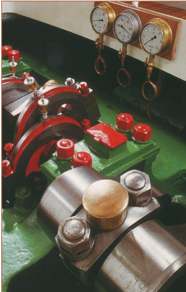
Abb. 2: Blick von oben auf die Kurbelwelle. Deutlich sichtbar die Pleuel der oszillierenden Zylinder, die Stevensonsteuerung und die Manometer alle Fotos: Sächsische Dampfschiffahrts GmbH & Co
