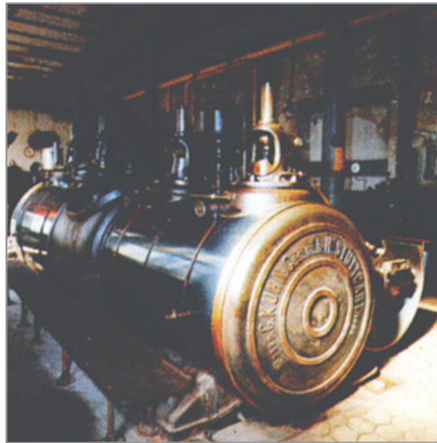
Kältekompressor der Firma G. Kuhn GmbH aus Stuttgart-Cannstatt von 1904
