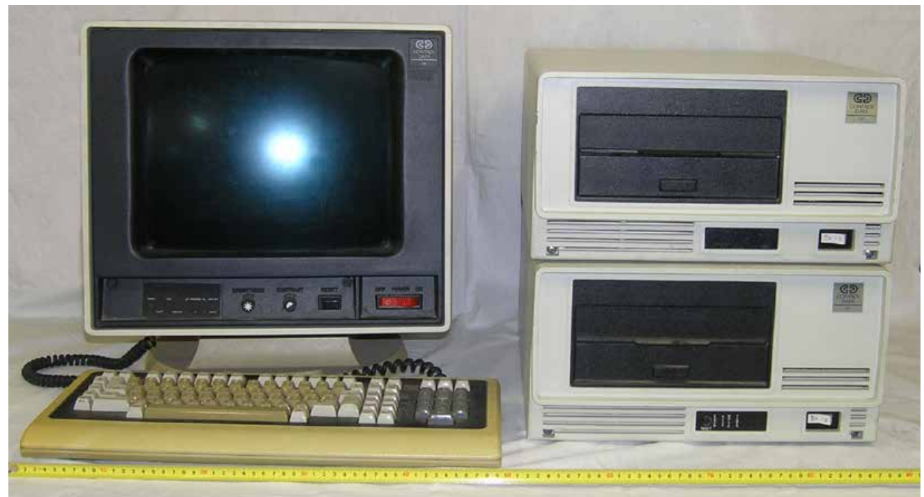
Das seit 1960 berühmte Control Data Plato Ausbildungs-System auf speziellem CD-PC mit berührungsempfindlichem grafischen Bildschirm und 8-Zoll-Floppy-Discs.
