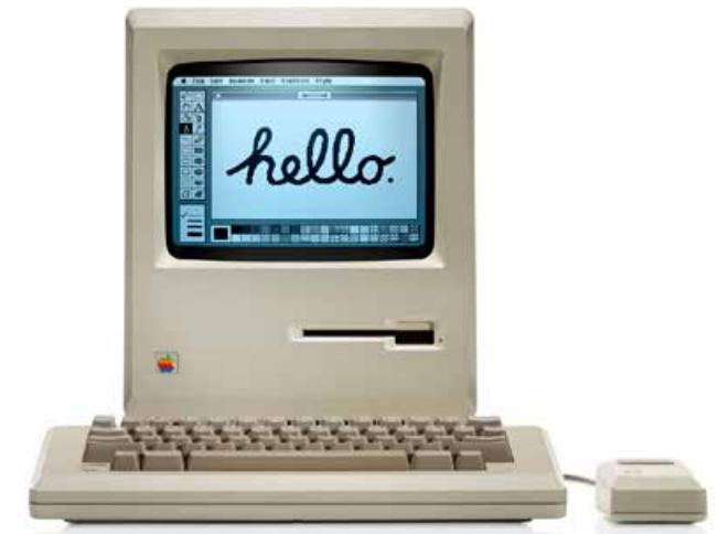
Der erste Macintosh 128k hatte eine 68000-CPU von Motorola, die mit 8 MHz getaktet war und auf 128 Kilobyte Arbeitsspeicher (RAM) zugreifen konnte. Ein 3,5-Zoll-Diskettenlaufwerk mit 400 KByte Speicherplatz, ein integrierter 9-Zoll-Monitor mit grafischer Benutzeroberfläche und eine Eintasten-Maus vervollständigten den Rechner. (beide Bilder: Wikipedia)
