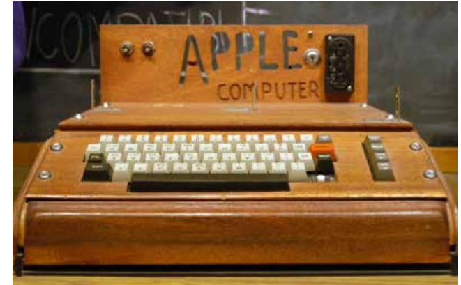
Der legendäre Apple I mit einer Videoschnittstelle, 4 KByte dynamischem RAM, einer Tastatur und dem Mikroprozessor 6502 von Rockwell International.
