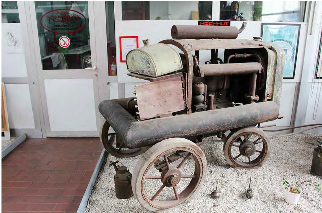
Ein unrestaurierter Kompressor Frankfurter Maschinenbau AG (FMA) aus dem Jahre 1911. Der wassergekühlte Kompressor, mit lenkbarer Vorderachse und gummibereiften Stahlrädern, besitzt einen U-förmigen Druckbehälter um den Kompressormotor. (Foto K.H. Steiner)
