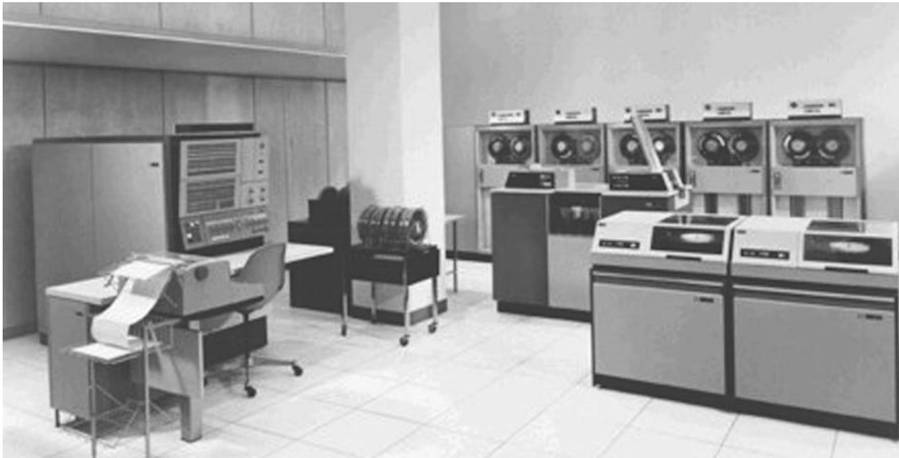
Rechner IBM 360/30 mit Konsolschreibmaschine 1052, Magnetbändern 2400, Magnetplatten 2311 und Leser/Stanzer 2540.
