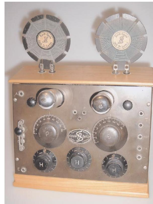
2-Röhrenempfänger SO 2A von 1925/26. Für Lautsprecherempfang wurde er um einen 2-Röhren-Niederfrequenzverstärker SO 2N erweitert. Bereichswechsel durch Austausch der Steckspulen.
