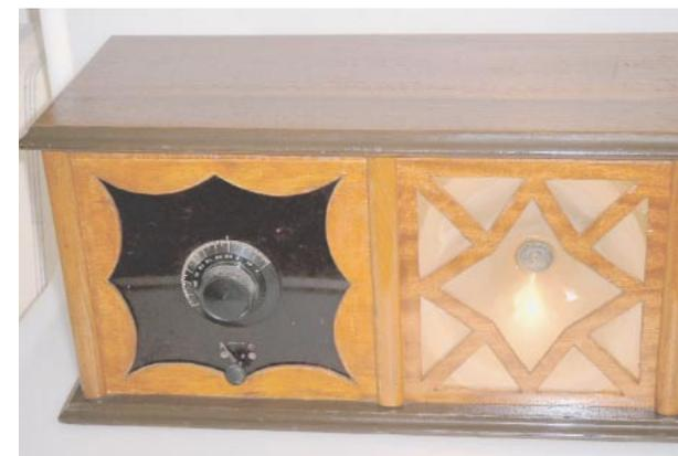
SO „Mignon“, Netzanschlussempfänger mit eingebautem Lautsprecher. Membran goldfarben, 1929.
