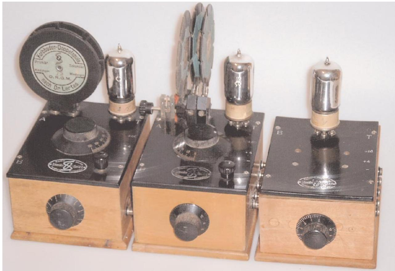
Von links nach rechts: Hochfrequenzverstärker, Empfänger, Niederfrequenzverstärker. Je nach Geldbeutel oder Empfangsbedürfnis konnte man sich sein Gerät zusammenstellen. Für Kopfhörerempfang und Ortssender reichte der 1-Röhren-Empfänger (Mitte). Für größere Lautstärke kam der rechts abgebildete Verstärker hinzu. Wer Fernempfang wünschte, benötigte den Hochfrequenzverstärker zusätzlich. Baujahr 1926.
