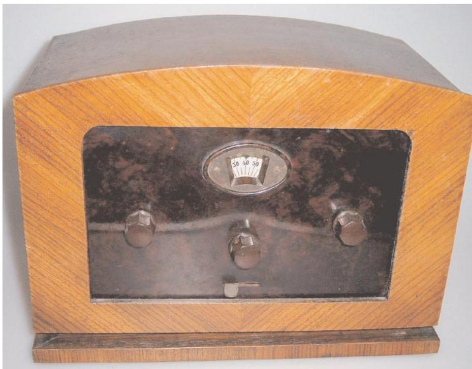
SO3W „Meteor“ Netzanschlussempfänger für separaten Lautsprecher, Baujahr 1931.
