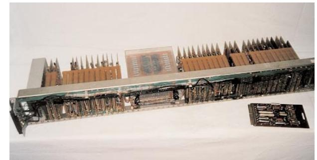
Abb. 5 Steckrahmen für Siemens 2002 mit Transistor-Karte (Q1998: 091,2)
