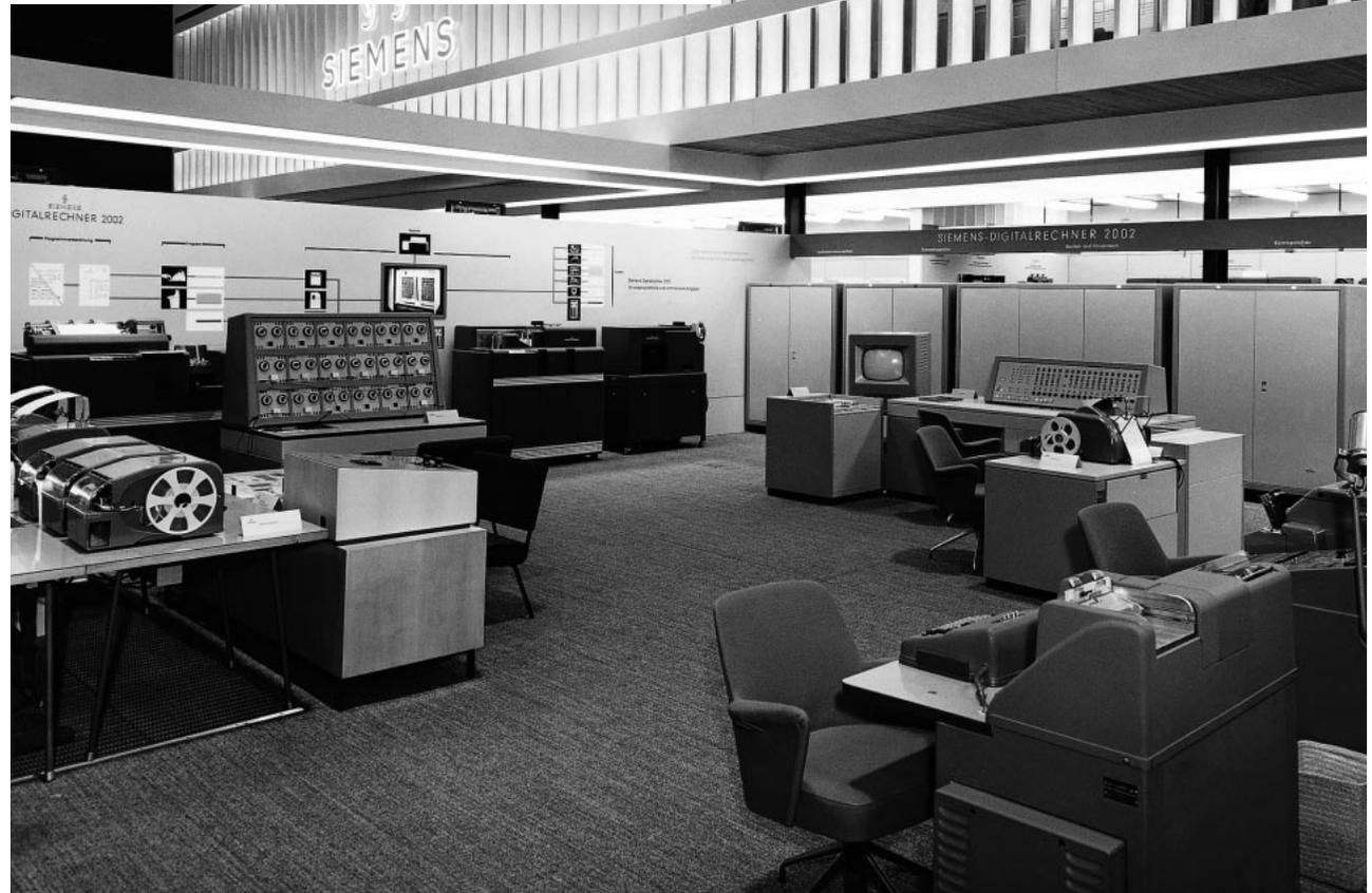
Abb. 1 Blick in ein Siemens Rechenzentrum mit Siemens 2002 Computer (Teile davon in FITG-Sammlung bewahrt, z. B. links Lochstreifen-Peripherie)
