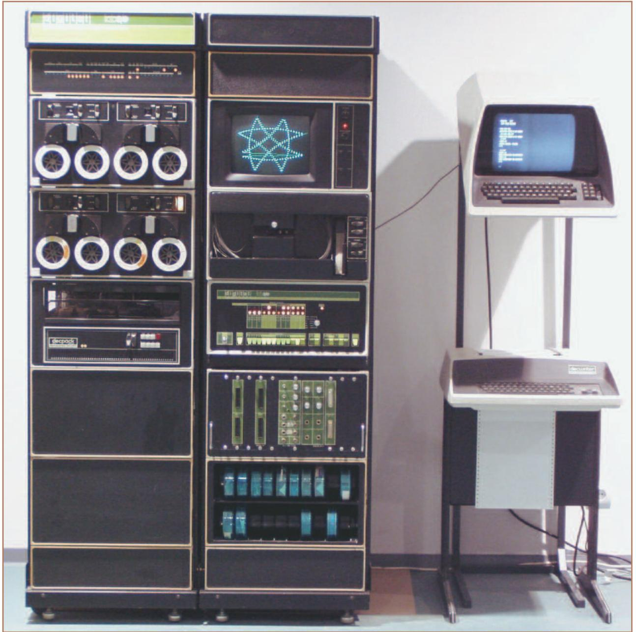
Bild 4: „Minicomputer“ der Firma DEC, Typ LAB 8e, Bj. 1970
