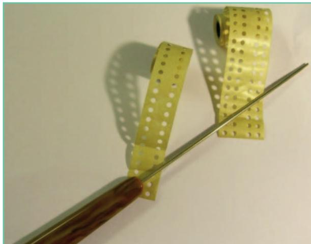
Nadel mit Klebestreifen zum Flicker falscher Lochungen, links für eine, rechts für zwei Lochreihen.
