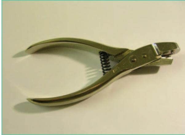
*Original-Schlitz-Kerbzange zum „Schlitzen“ der Randlochkarten. Wo man den Rand eingekerbt hatte, fiel die Karte beim „Nadeln“ heraus. Bei zweireihigen Karten konnte man „hoch“ und „tief“ kerben.*
