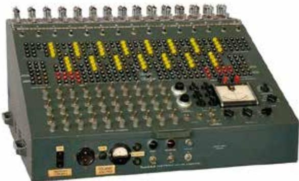
Bild 51: Heathkit Analog Computer
