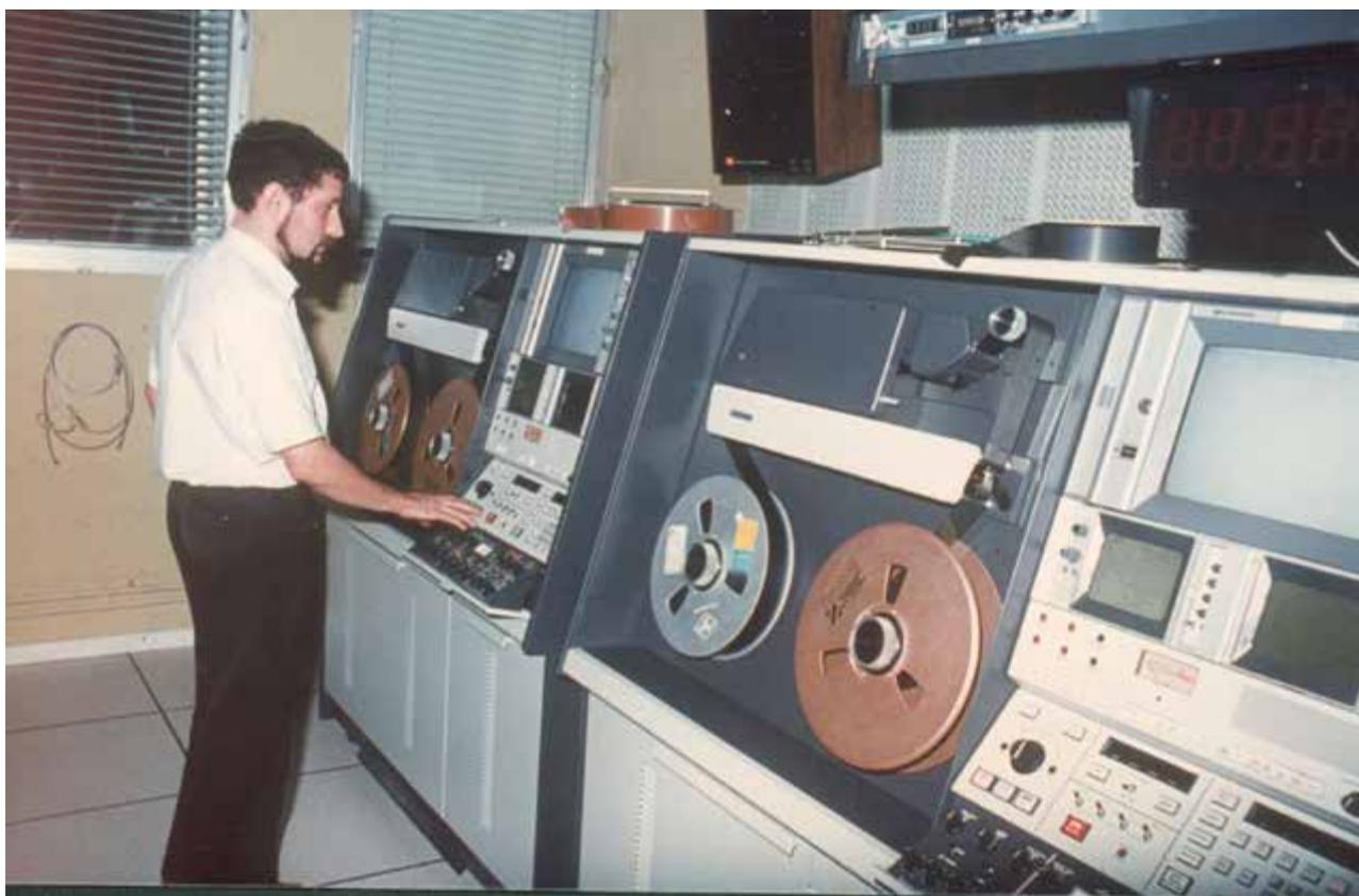
Bild 44: Magnéscope professionnel quadruplex (années 1975) AMPEX AVR3
